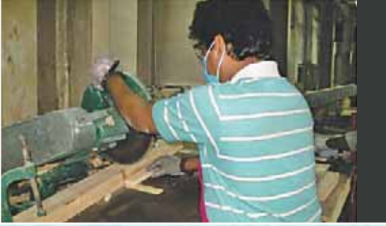
Mesh Gloves Used by Cutting Operator ಕತ್ತರಿಸುವ ಕೆಲಸಗಾರನು ಉಪಯೋಗಿಸುವ ಮೆಷ್ ಕೈಗವಸು
